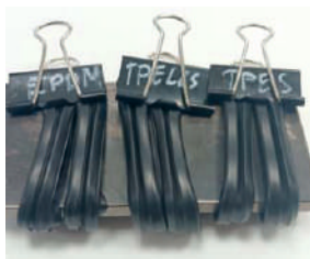
Рис. 1. Подготовка образцов к испытаниям на растрескивание при высоких температурах
