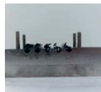
Рис. 6. Релаксация при +25°С образцов после 24 часов статического сжатия при -30°С
